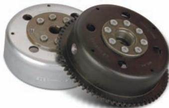
De plancha embutida y buje remachado
